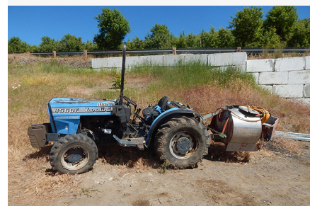
Incidente 2: Tractor con la ROPS levantada.
