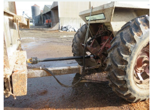
El capataz estaba parado en el frente del remolque sobre el eje la toma de fuerza (PTO) sin protección cuando el incidente ocurrió. (La foto muestra el eje de la PTO con la protección instalada)
