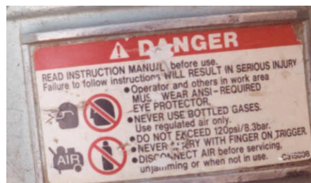
Etiqueta en la pistola de clavos para el uso de protección para los ojos.
