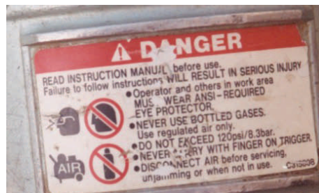
Se requiere protección para los ojos con etiqueta para su uso con pistola de clavos.
