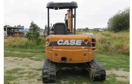
Excavadora que atropelló al instalador de tuberías que caminaba detrás de ella.
