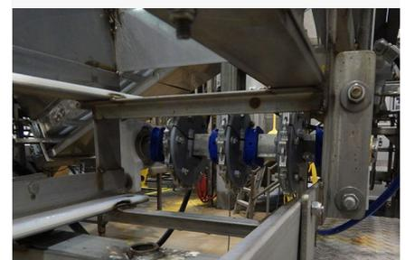
**Incidente 2:** La cinta y los engranajes del rodillo de la banda transportadora que atraparon el brazo del trabajador.
