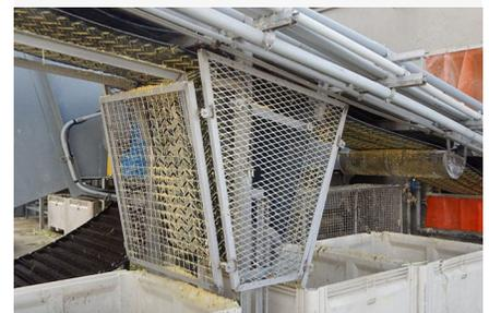
**Incidente 1:** Cinta y rodillos de la banda transportadora a los que el empleador puso una protección después del incidente. La protección está fundida al marco.
