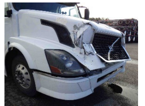
Daños en el camión sin conductor por chocar contra el chasis.
