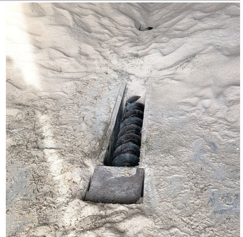
El barreno subterráneo en el que la trabajadora fue atrapada, con los protectores retirados después del rescate.
